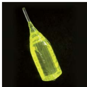
Figure 7. Cristal de grenat \text{Y}_3\text{Al}_5\text{O}_{12} dopé par l'ion terre rare cérium \text{Ce}^{3+} tiré par la technique de Czochralski de longueur 10 cm. Le domaine spectral bleu de l'éclairage naturel excite naturellement la luminescence jaune de l'ion \text{Ce}^{3+} .
