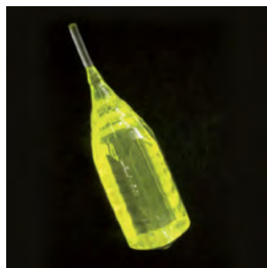
Figure 7. Cristal de grenat \text{Y}_3\text{Al}_5\text{O}_{12} dopé par l'ion terre rare cérium \text{Ce}^{3+} tiré par la technique de Czochralski de longueur 10 cm. Le domaine spectral bleu de l'éclairage naturel de la lumière visible excite naturellement la luminescence jaune de l'ion \text{Ce}^{3+} .
