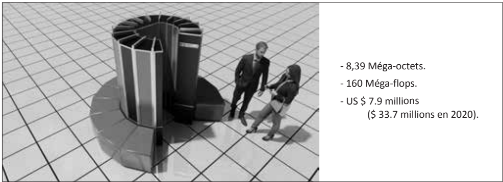
Figure 6. Le Cray-1 et ses caractéristiques.
